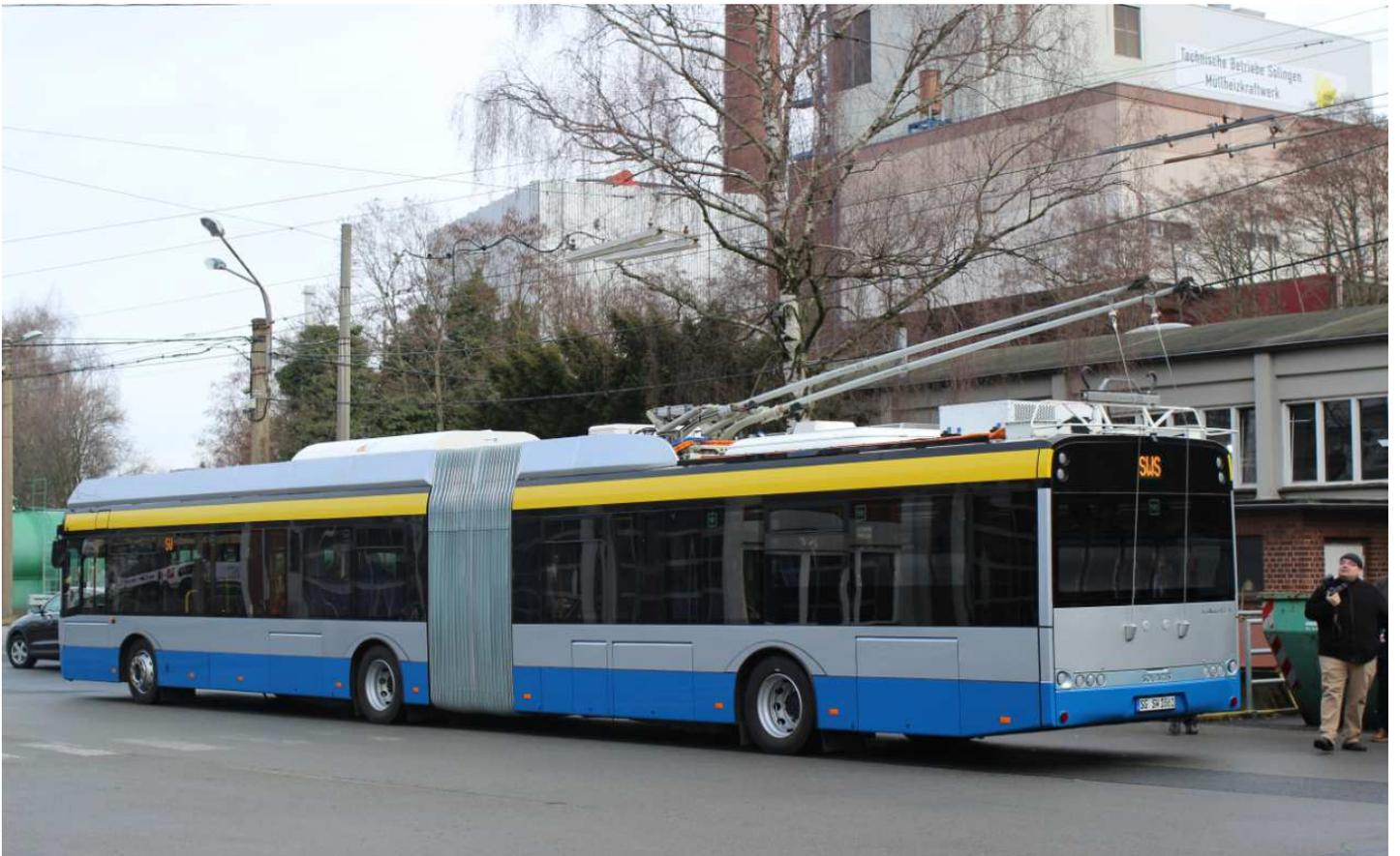
Auch das automatische Abdrahten wurde vorgeführt, zum Einbau gelangte die jüngste Neuentwicklung des Stromabnehmersystems der Firma Kiepe electric mit der Bezeichnung OSA 551.
