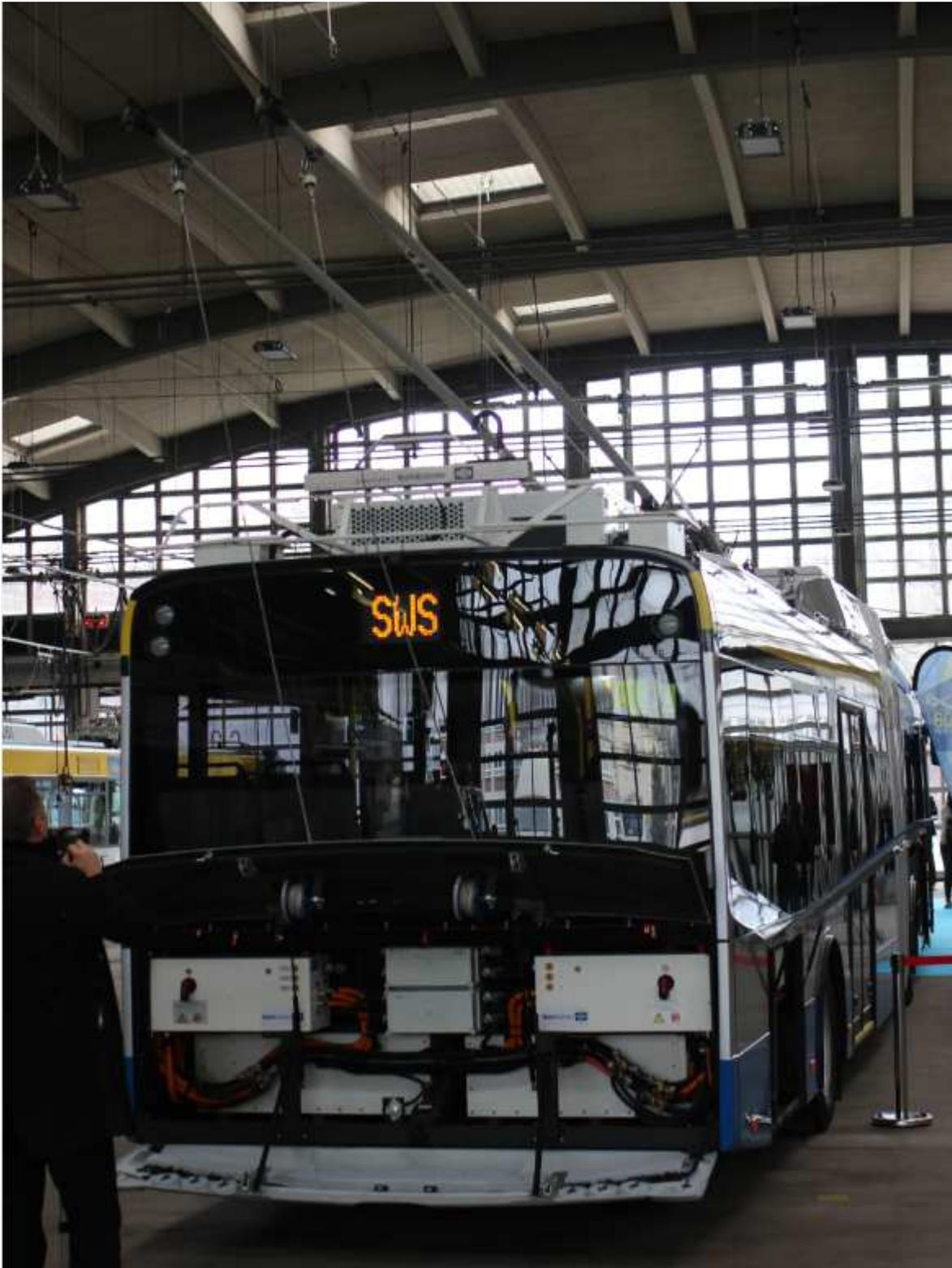
*Im geöffneten Fahrzeugheck sind zwei der Batteriepacks ganz unten sichtbar, die zwei weiteren befinden sich dahinter. Darüber befinden sich zwei Batterie Hauptschalter mit den Hauptschützen plus und minus sowie der DC/DC Converter, der wie bei Trolleybussen erforderlich eine doppelte Isolierung erhielt. Die Stromversorgung für Wasserkühlung (geführt durch die Schläuche vor den Batterien) befindet sich auf dem Dach des Nachläufers.*
